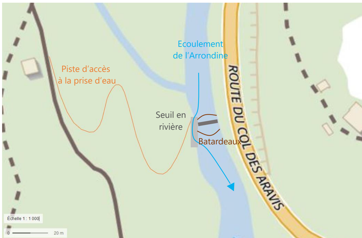
Figure 21: Construction du seuil en rivière. Source : Géoportail
